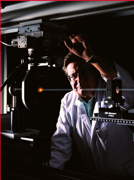
Dr. Stumpe untersucht diffraktive Elemente mit dem Spektragoniometer (Foto: Fraunhofer IAP, ftb Werbefotografie)
